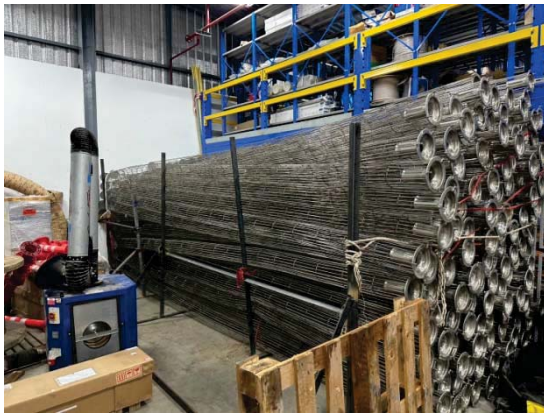
รูปที่ 13 อุปกรณ์และอะไหล่ของระบบ ดักฝุ่นละอองของหม้อไอน้ำ
